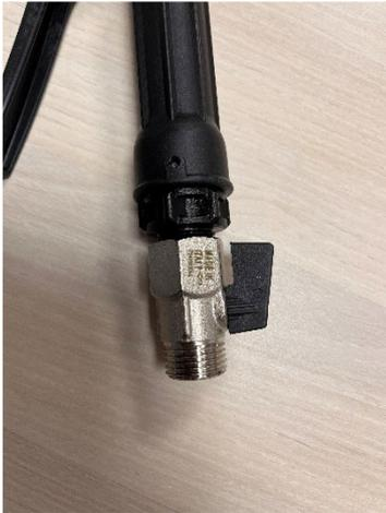
1-Visser la vanne d'arrêt au pistolet, et revisser le tuyau de la DR 5 à la vanne
