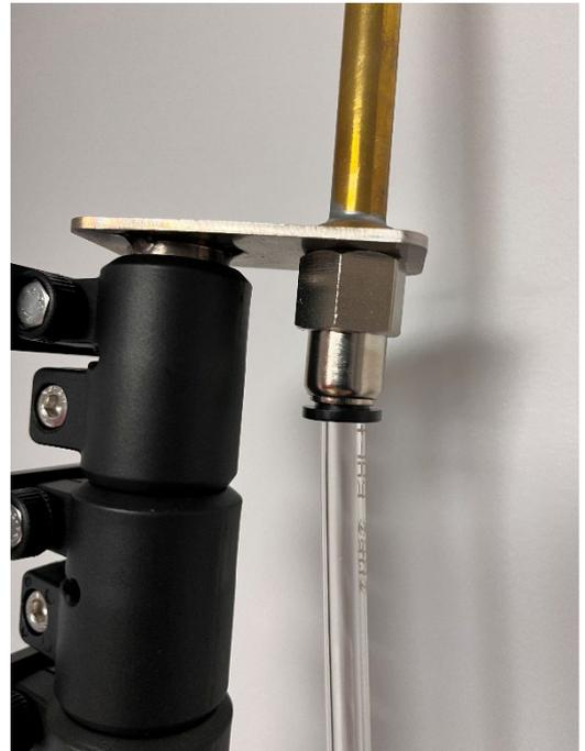
6- Remplacer la soupape de votre DR5 par la soupape 6 bars fourni.
