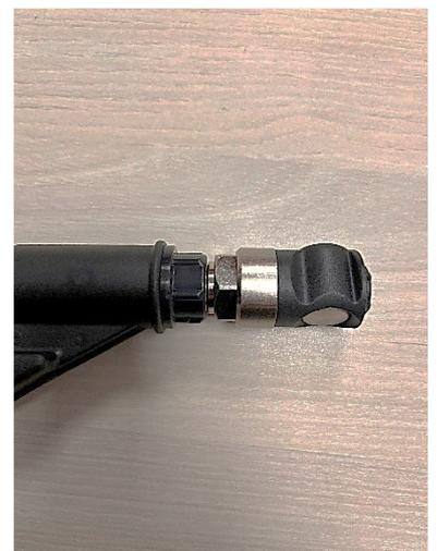
3-Inserer le tuyau transparent dans le raccord aimanté
